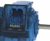
Mayor espacio interno y bloque de conexiones más accesible al usuario, contribuyendo para conexión y manejo más fácil de los cables. Las dimensiones fueron optimizadas para ofrecer mayor espacio para entrada de cables de la red y conexiones auxiliares, resultando un fácil montaje. La caja de conexiones puede ser montada arriba en la derecha o la izquierda del motor utilizando la misma carcasa.
