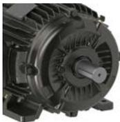
Los motores W22 Magnet son suministrados con rodamientos de larga vida útil L10h de 100,000 horas. También cuentan con cojinetes abiertos y tapas con pernos engrasadores que permiten la relubricación y disminuyen la necesidad de paradas para mantenimiento.
